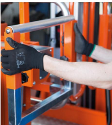
Rouleaux latéraux au Tool, réglables en hauteur et en largeur, pour faciliter les opérations de stockage
