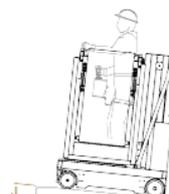
\* Charge maximale Vu que le poids de la plate-forme plus le chargement maxi-mum sur le panier sont complètement distribué sur un côté de la plateforme (le chargement totalement asymétrique).
