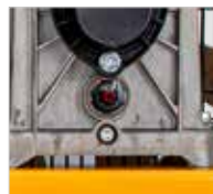
Fenêtre de contrôle du niveau d'huile
