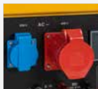
Monophasé - 230 V AC 50 Hz - Triphasé - 480 V AC 50 Hz
