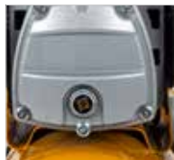
Fenêtre de contrôle du niveau d'huile
