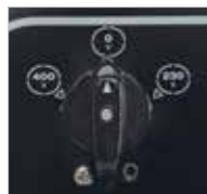
Sélection de la tension d'alimentation
