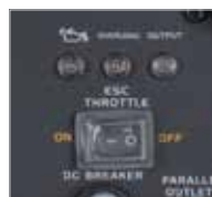
Interrupteur ESC (contrôle intelligent du régime moteur)
