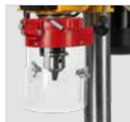
Écran de protection articulé contre la projection des copeaux
