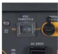
Interrupteur ESC (contrôle intelligent du régime moteur)
