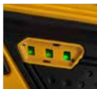
Voyant lumineux LED de l'état de charge de la batterie
