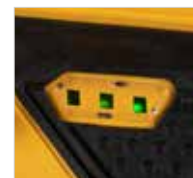
Voyants lumineux LED d'état de charge de la batterie
