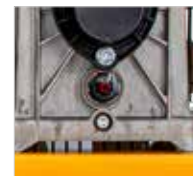
Fenêtre de contrôle du niveau d'huile
