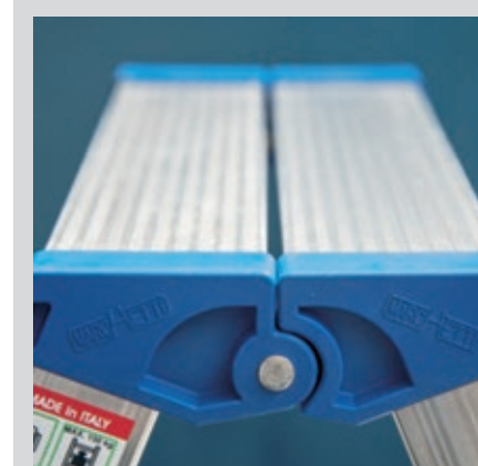
★ Plateforme avec charnière monobloc engagé dans les montants 380X175 mm
