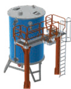
Échelle pour la maintenance des citernes
